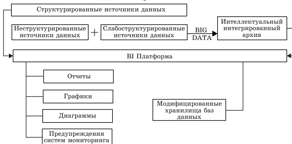
Рис. 2. Схема получения данных, основанная на использовании технологии больших данных и различных аналитических систем
